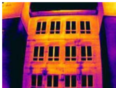
Fig. 2 Une thermographie peut révéler de nombreux points d'infiltration d'eau Source : Géroplex
