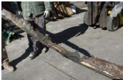
Fig. 7 Linteau d'acier totalement corrodé
