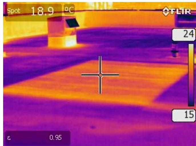
observée. Ensuite, une coupe exploratoire 'destructive' est effectuée pour prouver hors de tout doute la présence d'eau. Il n'est plus nécessaire de procéder à un remplacement complet de la toiture, seules les zones affectées peuvent être remplacées.
